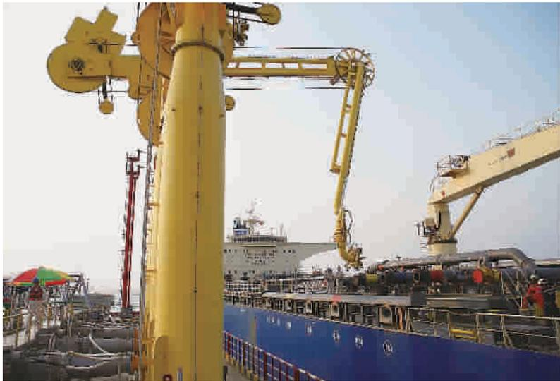
在缅甸马德岛港，港口工作人员帮助卸油臂与油轮原油管口进行对接 新华社发
