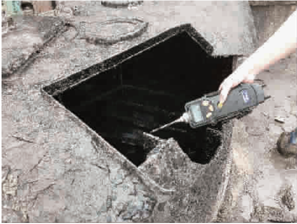
■ 执法人员用检测仪检查破损沥青原料罐
