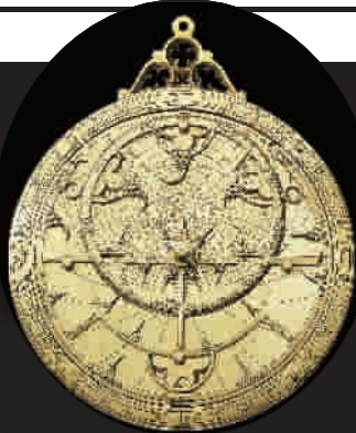
希伯来星盘，体现了当时最先进的科技——人们可以用它来导航、数学计算、判断星位和时间。
