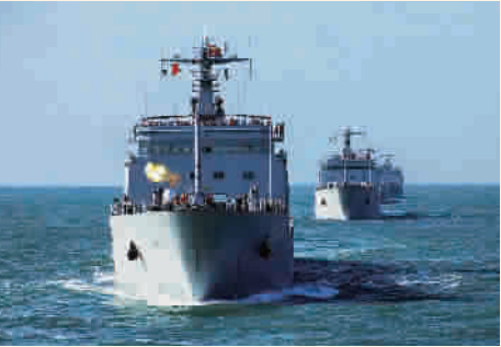
■ 东海舰队某登陆舰支队是人民海军历史最悠久的部队之一，近年来，他们列装国产新型坦克登陆舰，战时既可以锚泊换乘进行泛水登陆，又可直接冲击实施滩头登陆，在海空火力掩护下完成破水障、抢滩涂、巩固登陆场、接应后续部队等任务。（周鹏程摄）
