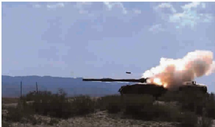
GL-5主动防护系统新落来袭火箭弹
