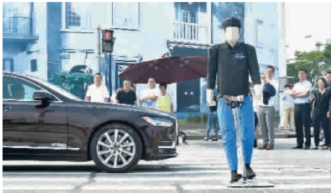
■ 封闭测试区内正在测试自动紧急制动系统 本版摄影 陈梦泽
