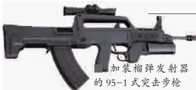
■ 加装榴弹发射器的 95-1 式突击步枪
