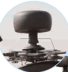
■ 直-19 直升机毫米波雷达特写
