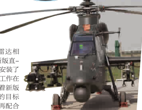
■ 直-19 直升机毫米波雷达特写
