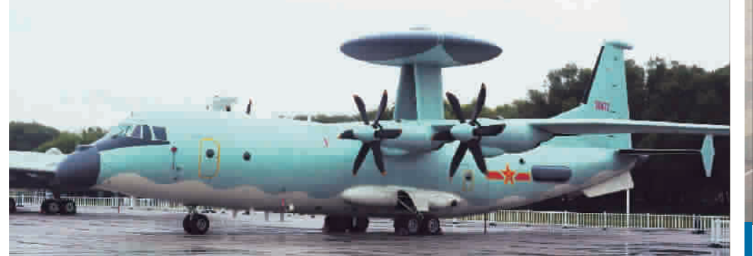
▲ 构型与空警-2000相似,但个头却小得多的空警-500,是中国预警机家族的“新剑客”。根据公开资料,空警-500率先采用数字阵列雷达,对比传统的有源相控阵雷达,它直接以数字的方法产生一定频率的发射信号,省却了多级复杂电路,重量大幅度减轻,体积大幅度缩小,特别适合于重量和体积限制严格的中小型飞机平台搭载。有分析称,正因为选用数字阵列雷达,雷达的关键部件收发组件能够做得又轻又小,这样在单位体积内就能安装更多组件,从而提高探测功率和距离,进而延伸对隐形目标的探测距离,因此空警-500具备隐形机探测能力是可以预期的 新华社
