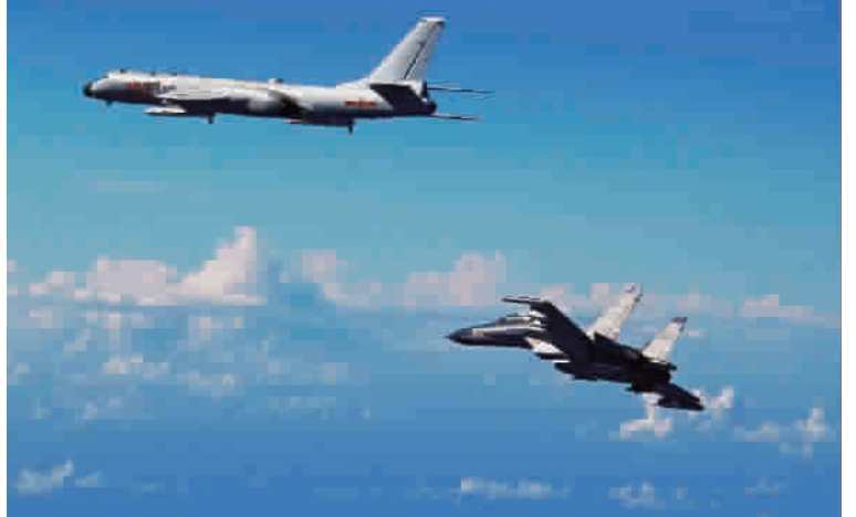
▲ 2016年9月25日,中国空军苏-30MKK歼击机掩护携带远程空地导弹的轰-6K轰炸机前出西太平洋远海训练。其中,轰-6K绰号“战神”,机头采用全封闭的流线形整流罩,加装多功能雷达,机头下方增加了一个光电吊舱,具备昼夜全天候目标搜索能力,并能对卫星制导或激光制导炸弹提供目标指示。轰-6K还增加了中国自行研制的数据库,能在保密状态下与上级单位或其他平台进行信息传递。中国空军主要将轰-6K当作“巡航导弹发射机”,具备精确的战役战术打击能力 新华社
