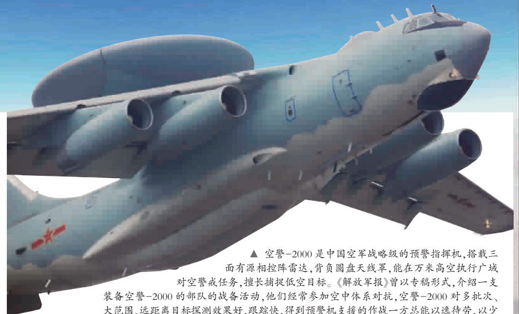
▲ 空警-2000是中国空军战略级的预警指挥机,搭载三面有源相控阵雷达,背负圆盘天线罩,能在万米高空执行广域对空警戒任务,擅长捕捉低空目标。《解放军报》曾以专稿形式,介绍一支装备空警-2000的部队的战备活动,他们经常参加空中体系对抗,空警-2000对多批次、大范围、远距离目标探测效果好,跟踪快,得到预警机支援的作战一方总能以逸待劳,以少胜多。空警-2000的电子系统结构是开放式的,可根据信息技术变化而持续升级 东方IC
