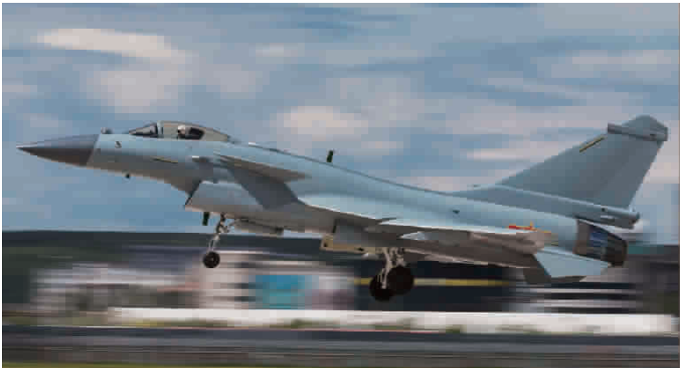
▲ 首度出征“航空飞镖-2017”国际军事比赛的中国歼-10B歼击机,相比早年服役的歼-10基本型,它取消了机头空速管,垂尾上方增加横条状电子设备舱,机头座舱前增加一部红外搜索与跟踪系统,能够辅助机载雷达对目标进行探测。歼-10B装有有源相控阵雷达,这是此类雷达在我军战机上首次列装,具备更强的目标探测能力、跟踪精度及稳定性,能够同时进行多目标攻击,意味着歼-10B是一款同时具备对空和对地(海)作战能力的中型多用途歼击机 新华社
