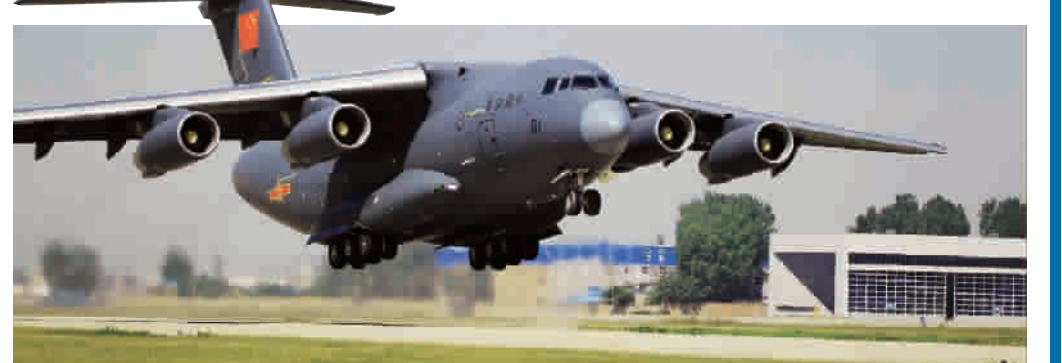
▲ 2016年7月6日,中国空军运-20军用运输机授装接装仪式在空军航空兵某部举行。运-20最大起飞重量220吨,最大载重66吨,这是中国首次依靠自身国防工业力量制造的战略运输机,可保障军队在更大范围内的机动性。运-20的总体性能超过俄罗斯伊尔-76运输机,并在超临界机翼、综合航电电子系统、驾驶舱设备、复合材料及加工等方面具有中国特色。专家称,运-20只由三名甚至两名机组人员操控,其宽敞的货舱可以运载解放军绝大部分大型作战和支援车辆 新华社
