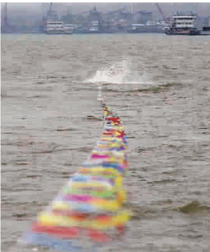
■ 缆线系声测设备，挂彩旗警示附近船只勿靠近
