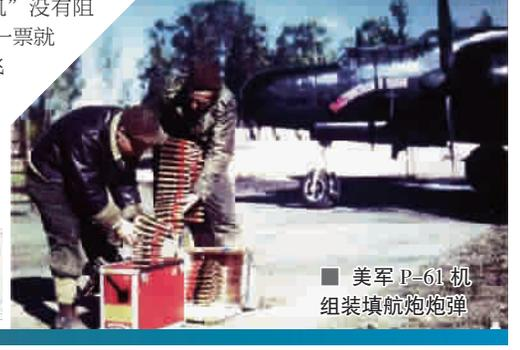
■ 美军P-61机组装填航炮炮弹
