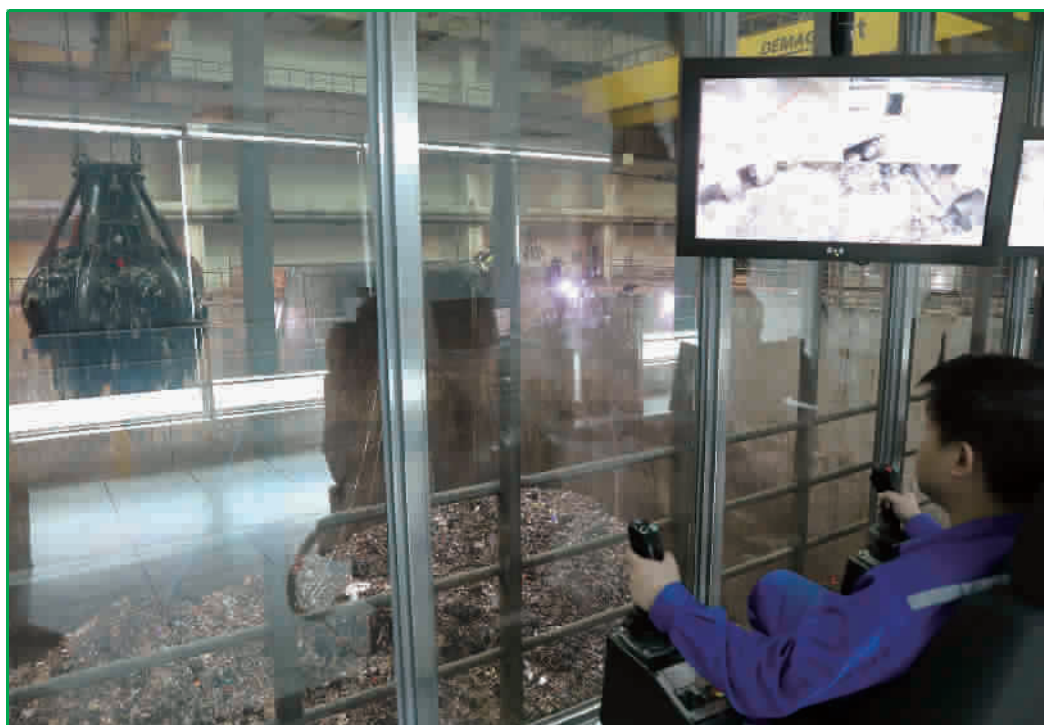
■上海老港再生能源利用中心是全国最大的生活垃圾焚烧厂之一,每个垃圾坑设置两台抓吊,液压多瓣型抓斗一次可抓取垃圾8吨左右 本报记者 王凯 摄
