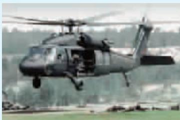
为了减少碰撞事故的发生，美国陆军将为 10 架部署在阿富汗的 UH-60L “黑鹰”直升机安装雷达图像增强系统。据美国内华达公司介绍，战场上的直升机坠毁事故有相当一部分是直升机与电线、电缆和电线杆等障碍物发生碰撞造成的。直升机自动着陆系统是内华达公司开发的一种新型产品，该系统重 45 千克，其中的 94GHz 雷达可产生周边地貌的三维图像，呈现于座舱显示器，覆盖在合成视觉地形图上。系统还可以在无法观察的情况下帮助飞行员自动起飞和着陆，从而避开电线和电缆等潜在障碍物。美国陆军希望了解下一代新型雷达能否在黑暗、恶劣天气或沙尘暴等严酷环境下帮助飞行员避开潜在威胁。
