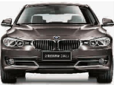
亮相。全新BMW 3系长轴距提供BMW 320Li、BMW 328Li和BMW 335Li三款车型,搭载三款采用BMW双涡轮增压技术的发动机,分别提供135千瓦、180千瓦和225千瓦的输出功率,均标准装备8速自动变速箱。配备运动设计套装(Sport Line)的全新第六代BMW 3系在北京车展上推出,豪华设计套装(Luxury Line)和风尚设计套装(Modern Line)将向全新BMW 3系长轴距提供。
