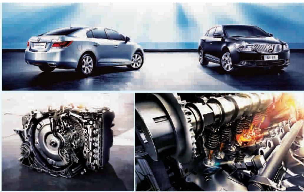
合器压力控制的精确性,不需要再提供大油压来补偿外在因素变化(如温度)的影响,这使得与之匹配的发动机获得大约2%的燃油经济性。同时,这款全新变速箱还采用了全新材质的离合器摩擦片,并且减少摩擦面积,降低了变速箱损耗。高精度齿轮组的使用,同样减少了变速箱运转中的能量损耗。
