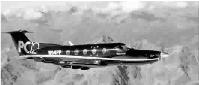
■ 美军在非洲搜集情报的主力机型“皮拉图斯”PC-12型单引擎涡轮螺旋桨式飞机
