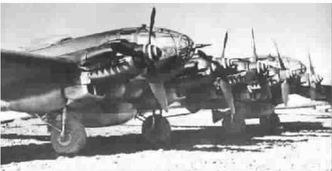
德军He111Z双体滑翔机牵引机由2架He111拼装在一起,有5个发动机
