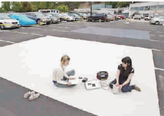
■ 热岛集团研究人员获取伯克利实验室新临时停车场“降温”路面的热测量值
