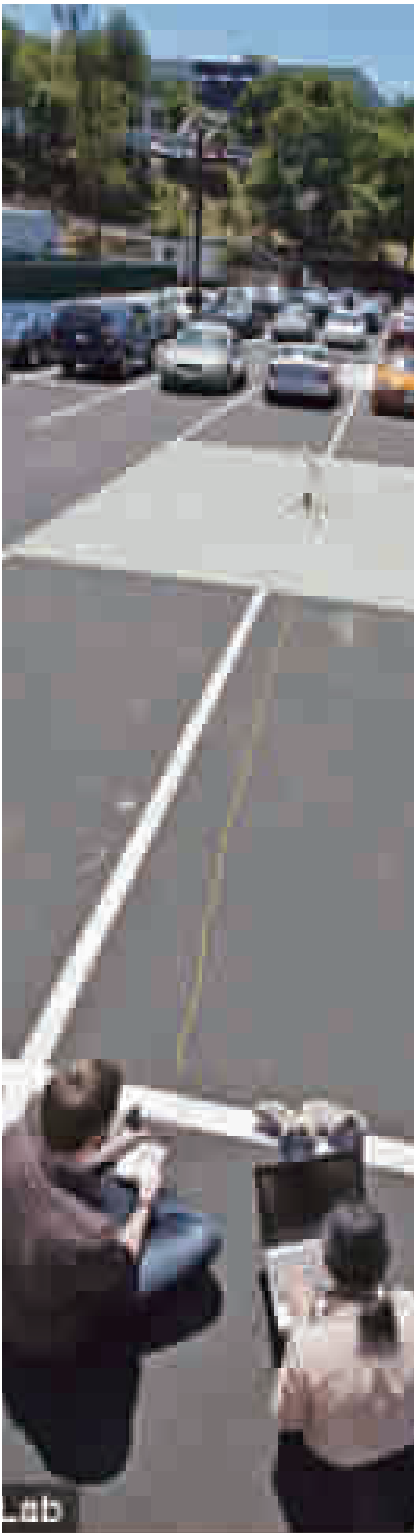
■ 加州伯克利分校热岛集团的莎朗·陈和安娜·宝拉·韦勒,正在测量收集有关伯克利实验室新临时停车场“降温”路面太阳热反射涂层的数据
