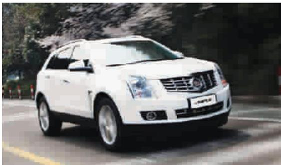
SRX搭载了3.0升和3.6升两种动力版本,其中全新配备的3.6升V6全铝智能直喷发动机曾荣膺“全球十佳发动机”殊荣,最大功率234千瓦,最大扭矩359牛米,百公里加速仅需7.4秒。与强劲动力所匹配的6速手自一体自动变速箱,可提供巡航、运动、手动和ECO燃油经济四种驾驶模式。全新SRX还搭载了e-AWD智能全驱系统,包括一般道路、高速巡航、高速超车、高速过弯和越野等五种模式应对多重路况。
