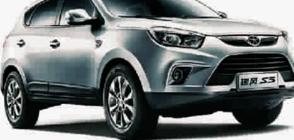
全、舒适、节能、环保、人性等方面的换代革新优势。其搭载的1.8T涡轮增压发动机,最大功率为120Kw,最大扭矩235Nm,均全面超越同级车型,在保证动力性的基础上有效改善燃油经济性。该车还采用了EPS电动转向,这也是在自主品牌同类量产车型中率先运用。安全配置方面,除了大量超强钢应用之外,ESC车身稳定、HBA紧急制动辅助、TCS牵引力控制、上坡辅助、陡坡缓降、TPMS胎压监测等这些在豪车上才能见到的系统配置,瑞风S5也一一具备,即使是对垒合资品牌也不落下风。
