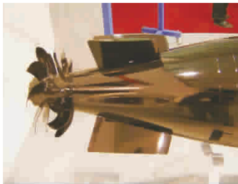
■ “黑鲨”鱼雷采用电池驱动的11+9叶对转桨
