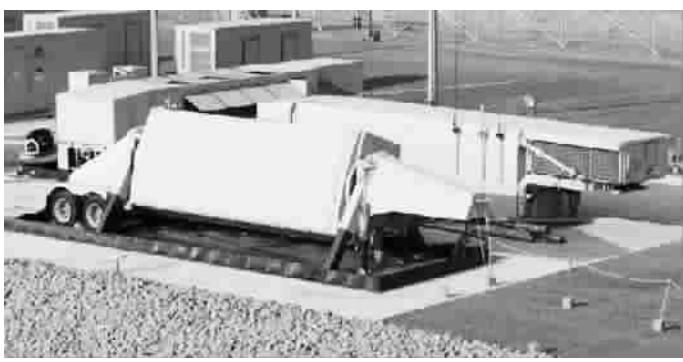
美国雷神公司研制的AN/TPY-2机动反导监视雷达(资料图)
