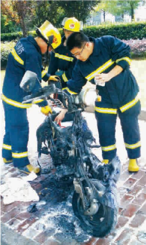
昨天上午，田林路近古美路一侧人行道上停放的一辆轻便摩托车发生自燃。消防人员赶到将火扑灭后初步查明，这起自燃事件是高温暴晒及车辆线路老化所致。为此，警方提醒，夏日高温期间广大车主主要特别注重定期检查，了解车辆的状况，及时排除安全隐患。
