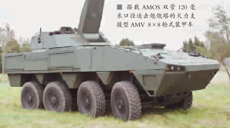
■ 搭载 AMOS 双管 120 毫米口径迫击炮炮塔的火力支援型 AMV 8×8 轮式装甲车
