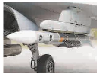
瑞典空军今年 6 月利用萨博公司的“鹰狮”测试战斗机成功试射 MBDA 公司的“流星”超视距空对空导弹。该型导弹采用固体冲压发动机，推力可调节，最高速度可达 4 马赫，射程约 150 千米，末制导采用 X 波段主动雷达，战斗部可配备近炸和触发式两种引信。
