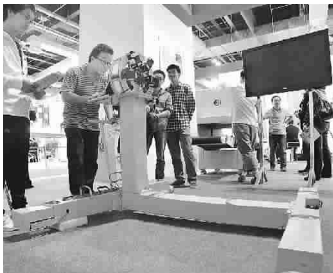
同济大学的隧道病害快速检测仪，可以进行隧道结构渗漏水等统计分析 本报记者 孙中钦 摄
