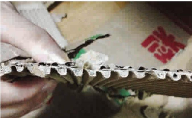
瓦楞纸缝隙里塞满了填充物
