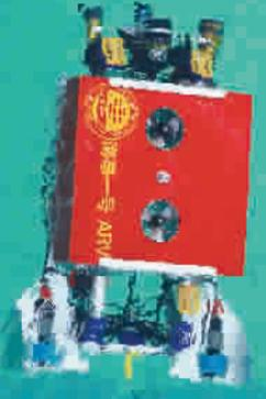
自主识别环境,回避障碍物,还能把海底下的地形、地貌等图像传递到水面船只的操控平台上……记者在上海海事大学水上训练中心看到,水下机器人与智能系统实验室朱大奇教授科研团队自行研制的一款新型水下机器人“海事一号”浮出水面,亮相中国国际工业博览会。
