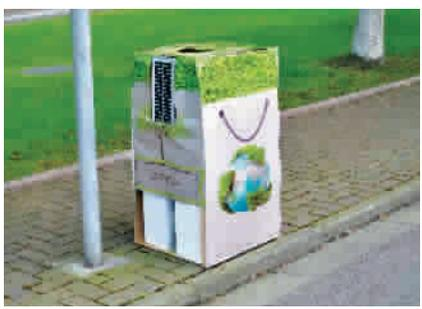
由上海理工大学研发综合运用吸附和催化氧化方法的空气净化器亮相工博会,它将解决吸附型易饱和、光催化型产生副产物等现有净化器瓶颈,达到持续、稳定、高效的净化效果。
