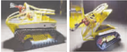
■ Thermite 遥控机器人可执行各种险恶的消防任务
