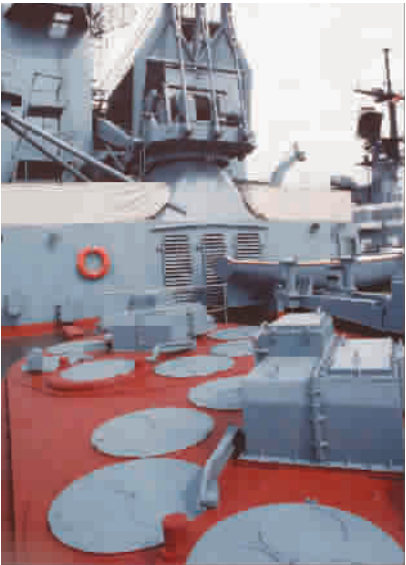
▲ 安装在“瓦良格”号巡洋舰上的“暗礁”防空系统导弹垂直发射装置
