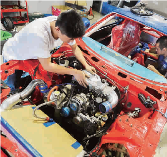
▽ 改装师将发动机拆下,加固改装后重新装回车内
