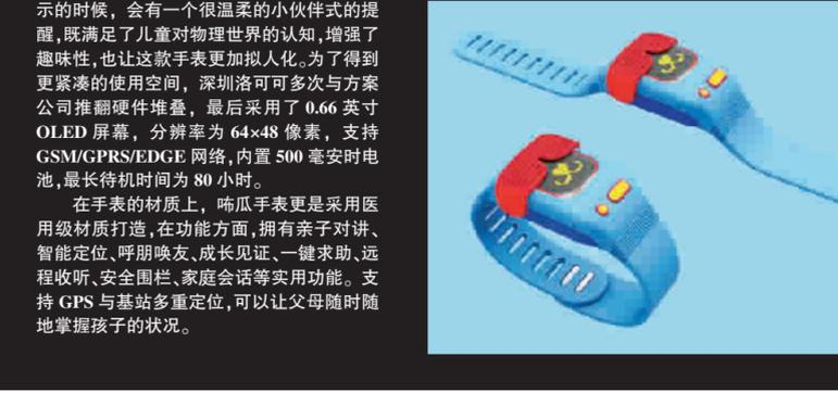
一款用设计表达爱的科技产品。呱呱亲子智能手表创意来源于时下热播的《爸爸去哪儿》节目,设计主题定义为“儿童伙伴”,意在打造一款具有儿童专属性的智能可穿戴产品,简单易用,并且情感化。基于赋予这款亲子智能手表“有生命”的理念,呱呱加入了许多独特的设计。比如,外观上加入了一个眼镜的小配件,在有消息提示的时候,会有一个很温柔的小伙伴式的提醒,既满足了儿童对物理世界的认知,增强了趣味性,也让这款手表更加拟人化。为了得到更紧凑的使用空间,深圳洛可可多次与方案公司推翻硬件堆叠,最后采用了0.66英寸OLED屏幕,分辨率为64x48像素,支持GSM/GPRS/EDGE网络,内置500毫安时电池,最长待机时间为80小时。在手表的材质上,呱呱手表更是采用医用级材质打造,在功能方面,拥有亲子对讲、智能定位、呼朋唤友、成长见证、一键求助、远程收听、安全围栏、家庭会话等实用功能。支持GPS与基站多重定位,可以让父母随时随地掌握孩子的状况。
