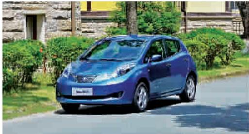
以聆风为基础打造的启辰晨风动力系统由高效能锰酸锂电池、同步永磁电机以及先进的电控系统构成, 加速迅猛, 一次充满电在综合工况下可行驶 175km。
