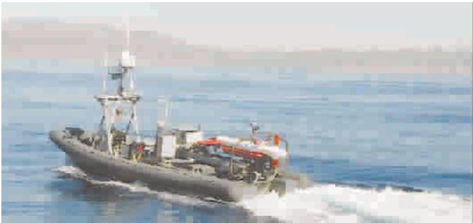
■ 搭载AQS-24A水雷探测系统的无人水面猎雷艇
