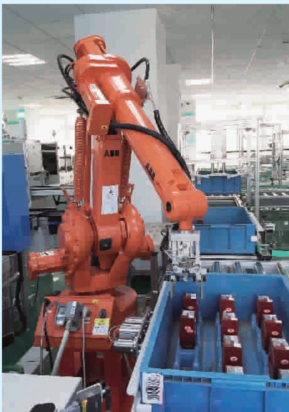
■ 电能表自动化检定流水线在工作
