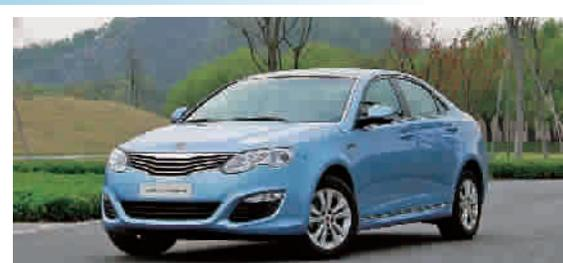
2015 款荣威 550 Plug-in 插电式混合动力车型,改装了全新的 1.6L 发动机+电动机的动力总成,在核心动力科技、智能配置、静音等多个方面有显著提升,纯电续航里程提升至 60km。
