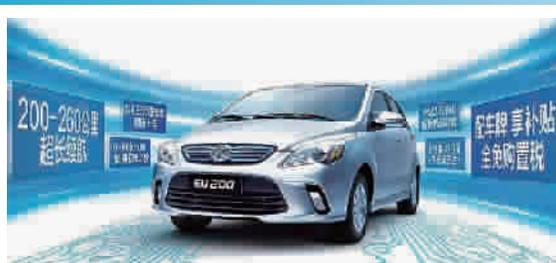
北汽新能源 EV160 轻秀版和 EV200 轻快版,搭载北汽自主研发的永磁同步电机,分别采用磷酸铁锂电池和三元锂电池,前者续航里程为 160—190 公里,后者续航里程为 200—240 公里。
