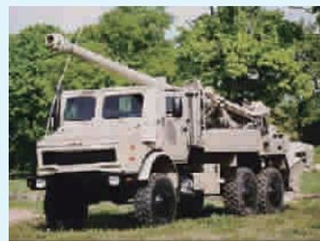
沙特阿拉伯已向法国奈克斯特系统公司追加订购了一批“凯撒”自行榴弹炮。早在2011年9月,沙特阿拉伯就与奈克斯特系统公司签订了一份价值2.1亿美元的合作,订购32门“凯撒”自行榴弹炮,这批榴弹炮有望于2013年底至2014年期间交付。沙特阿拉伯接收的“凯撒”榴弹炮是将52倍口径155毫米火炮安装在德国U5000“乌尼莫克”卡车底盘上,并配有泰勒斯公司的ATLAS火控系统、萨吉姆公司的西格玛惯性导航系统、ITT Exelis公司的单信道地面与机载无线电台、动力管理装置以及炮口测速雷达。沙特阿拉伯还为“凯撒”榴弹炮订购了“伯纳斯II”攻顶反坦克弹药,7套乘员训练系统以及超过60套奈克斯特系统公司新研制的弹道计算机炮兵自主操控系统。
