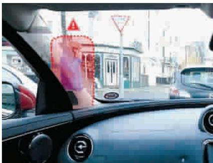
■ 左侧屏幕显示被遮挡的车外行人 图 GJ
