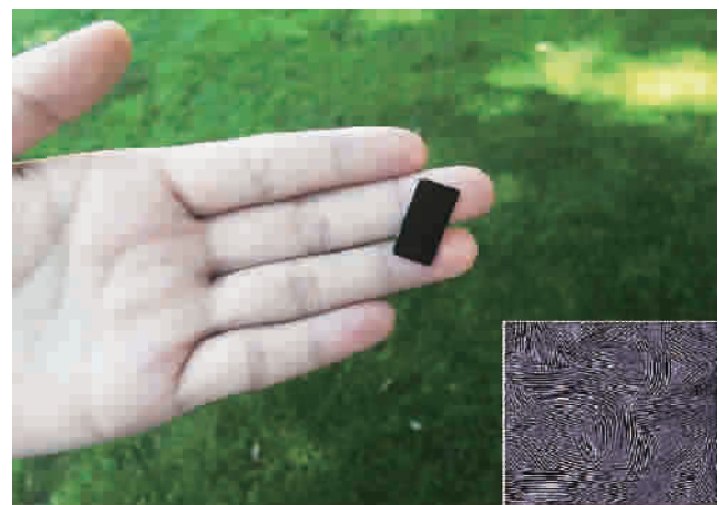
图 Jin Xie/Stanford ■ 纳米结构设备,20分钟内用可见光杀灭细菌 谢瑾(斯坦福大学)
