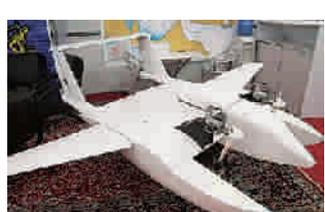
伊朗伊斯兰革命卫队10月26日展示一款无人驾驶飞机,既可执行侦察任务,也可装载炸药用于自杀式攻击。从发布的照片看,这款无人机外形像一艘双体船,双垂尾,有2部螺旋桨引擎。据称,它的航程可达1000千米,续航时间2小时,配备的相机既可在白天也可在夜间拍摄。当执行自杀式攻击任务时,它可在距水面约半米高度以每小时250千米的速度冲向目标。
