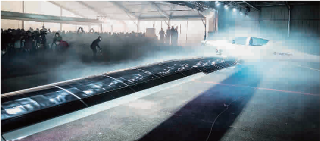
■ 长22米的太阳能电池板覆盖双侧机翼表面。
