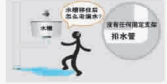
聚通为你解决：排水管增加固定支架，有效防止排水管接口松动造成的漏水现象。
