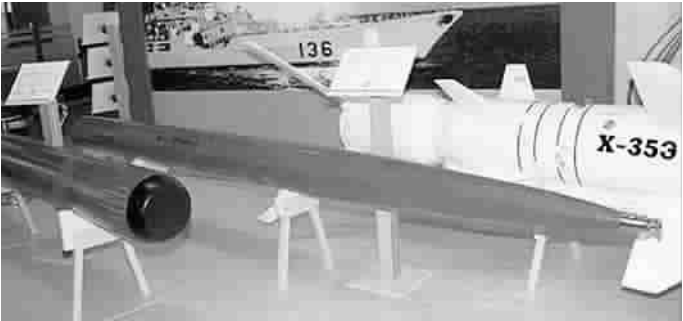
■“暴风雪”鱼雷能以200节的超高航速对敌方舰艇进行打击
