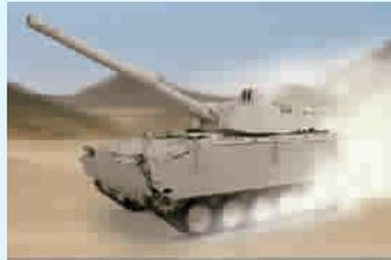
CMI 防务公司和斗山防务技术公司在阿布扎比防务展上展示了一种新型 120/105 毫米口径中型坦克概念。该系统集成了“柯克里尔”(Cockerill)公司的 XC-8 炮塔和斗山公司的 K21 步兵战车底盘,重约 25 吨,具有很高的操作灵活性和战术机动能力。
