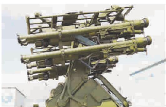
“弓手-E”防空系统上安装的“针-S”防空导弹
