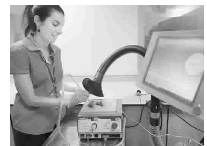
“智能”手术刀 英国帝国理工大学研究人员开发出一种“智能”手术刀，与质谱仪相连，可对高温切除癌变组织时产生的烟雾进行分析。
