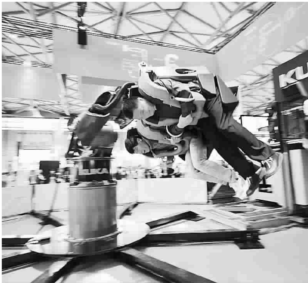
■ 首次展出的载人娱乐机器人“Robocoaster”,第一次将工业机器人应用到娱乐业
