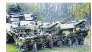
据悉,一家俄罗斯公司已完成新型扫雷系统的研制工作。名为TMS-S的扫雷系统有8个扫雷辊安装在铰链臂上,两侧都装有刀片,能切断控制爆炸的线路,扫雷辊上方有2个杆型电磁装置和地雷“拖网”。该系统可安装在俄制BMR-3M装甲车前方,系统重约13吨,能在95分钟内完成安装,但只需30秒就能卸掉。后部的烟火信号器能为后续车辆指出“干净”的道路。
