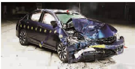
动车型的动力电池系统没有任何影响，舱内的混合动力电路系统没有发生任何漏电。两个小时后，本田公布了碰撞实验数据。结果显示，车内乘员假人的测试伤害值远远低于法规标准，而最受公众关心的混合动力系统的电路和电池等核心部件没有任何漏电异常。换言之，碰撞中，无论是乘客，还是车内的电池组、电线等，其安全均得到了最大程度的保护。
