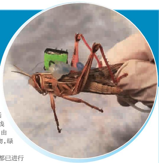
生物世界里,探测爆炸物的高手何在?人类已经有了嗅炸药的狗、老鼠,还有海豚;而戴着小背包的昆虫可能很快加入这个尖端技术的行列。美国华盛顿大学圣路易斯分校工程师正在开发半机器人版的蝗虫,将在远程控制下飞入危险区域,借助自己的触角嗅出爆炸物,并在发现它们时发出无线警报。
