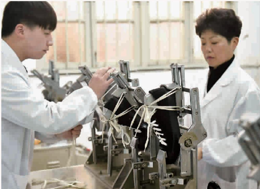
■ 工作人员正用整鞋屈挠机对样品进行检测
